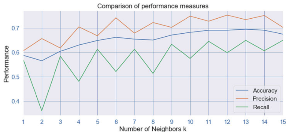
Abb. 14.4 Optimaler Hyperparameter des KNN Modells
